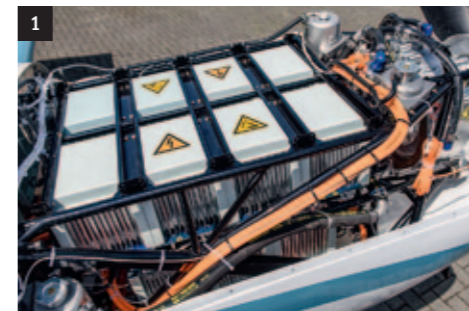
1 | Zellteilung: Ein Akkublock ist direkt hinter dem kleinen Motor eingebaut, ein zweiter auf dem Vordersitz. Gesamtgewicht: 300 Kilogramm
