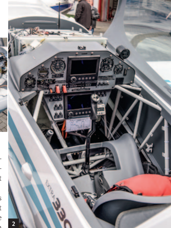
2 | Elektrischer Stuhl: Das Cockpit der Extra 330LE zeigt sich aufgeräumt, die Bedienung des Motors ist im Vergleich zum Verbrenner relativ einfach
